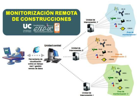
Así, en primer lugar, se ha realizado un **levantamiento de los daños existentes** para a continuación hacer un seguimiento de los mismos, tanto a través del **control manual discontinuo**, con la ayuda de un deformómetro y un equipo de medida de inclinaciones portátil, como de la **instrumentación en continuo** a través de diversos sensores y sistemas de adquisición, y el desarrollo de una herramienta para la **gestión remota de los datos**.
